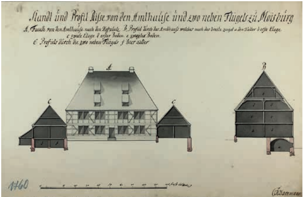
Abb. 6 Bestandszeichnung des Amtshauses in Moissburg (Ansicht u. Schnitte). C. H. Havemann, um 1759. NLA HA, Kartensammlung, Nr. 33 g Moissburg 3 pm.
